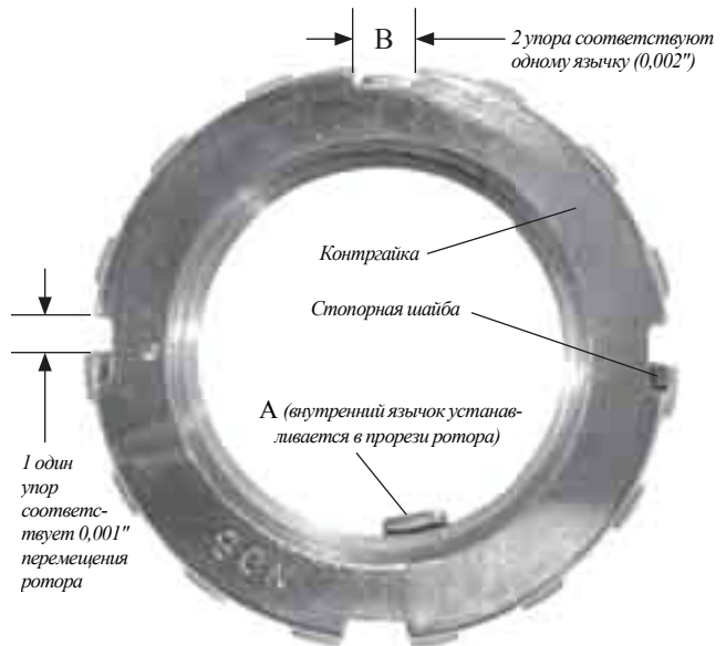
Рис. 9: Регулировка контргайк и стопорных шайб
